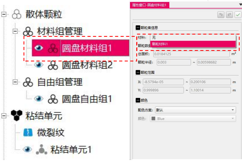
点击上下夹具的圆盘材料组，赋材料属性
